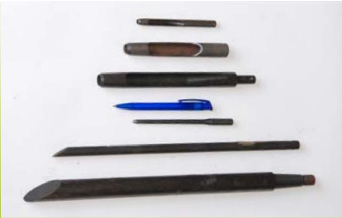
**Vollspoons:** Sind Metallstifte die nur Löcher stechen ohne Material zu entnehmen. Die große Maschine kann mit langen, dickeren Spoons bestückt, im Boden mit einer Pendelbewegung eine besonders gute Tiefenlockerung erreichen (Grabgabeffekt). Mit kleinen Spoons wird der Boden nur in der Oberzone geöffnet, um den Gasaustausch und die Wasserinfiltration zu verbessern
